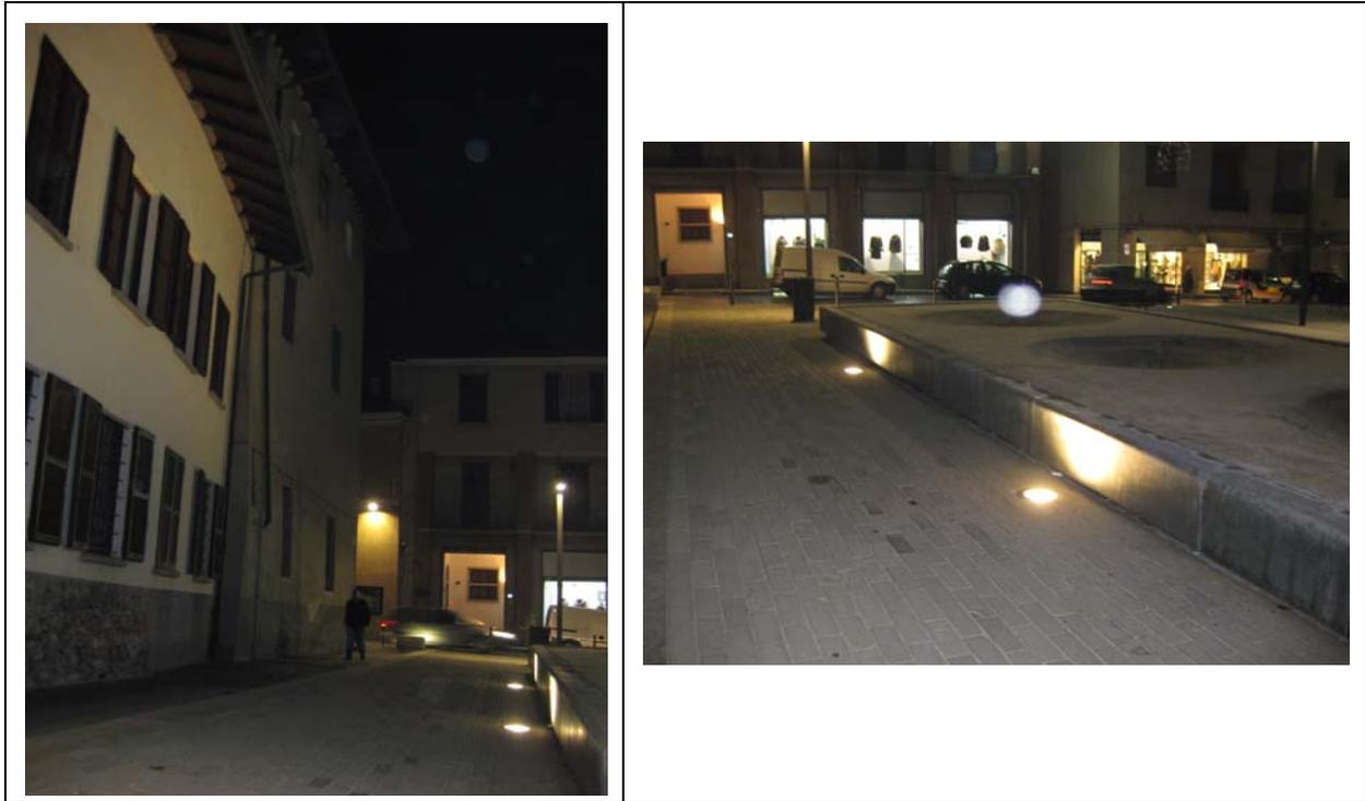
La presenza di faretto del tipo calpestabile in prossimità dell'edificio ha rilevato come l'eccessiva luminosità degli stessi e l'errato posizionamento faccia sì che la luce si rifletta abbondantemente sulla facciata, creando disturbo visivo.
