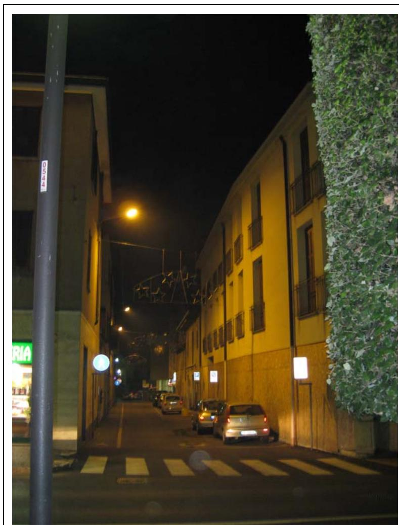
Tale via è risultata notevolmente sovrailluminata con presenza di corpi illuminanti che generano luce fortemente intrusiva sulla facciata dell'edificio antistante. I valori rilevati variano da 6,55 cd/mq fino ad un massimo di 7,61 cd/mq.
